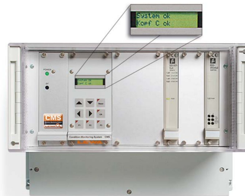
Bei der Inbetriebnahme der Pumpe wird der Gutzustand erlernt und gespeichert. Im Betrieb wird der jeweils aktuelle Zustand mit dem Erlernten verglichen.
